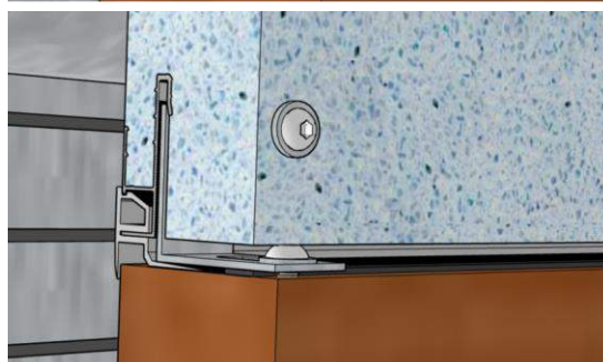
Figure 35 - Fixation de l'aile intérieure au dormant de la menuiserie
