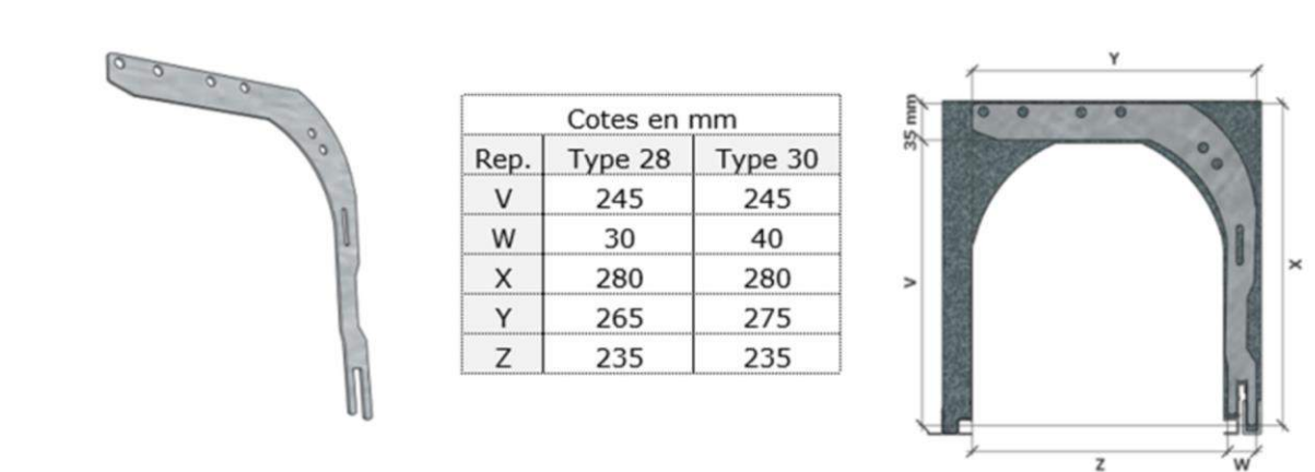
Figure 24 - Renfort en acier galvanisé pour coffres renforcés
